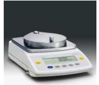
Mikrowaage zur Wägung von Filtern mit metallischem Aufsatz
