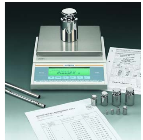
Externe Kalibrierung und Justierung einer Präzisionswaage
