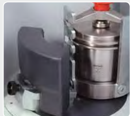
Zur optimalen Auswuchtung lässt sich das Gegengewicht der PM 100 auf einer schrägen Führungsschiene einstellen
