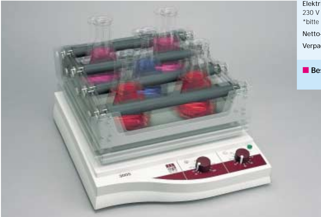
3005 Analoger Kreis-Schüttler mit Universal-Aufsatz
