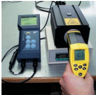
Überprüfung eines Infrarotmessgerätes
