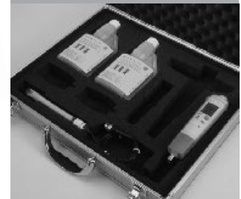
Einhand pH/°C-Messgerät, pH3-Sondenkopf mit BNC-Schnittstelle, pH-Sonde Typ 01, Aufbewahrungskappe mit Gel, Kalibrierdosierflaschen 250 ml pH 4+7, TopSafe, Gürtel-/Wandhalterung und Alukoffer
