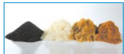
Hochwertigste Materialien sind der Garant für höchste Qualität. Von links nach rechts: Aktivkohle, Anionen-, Mischbett- und Kationenaustauscherharz.
